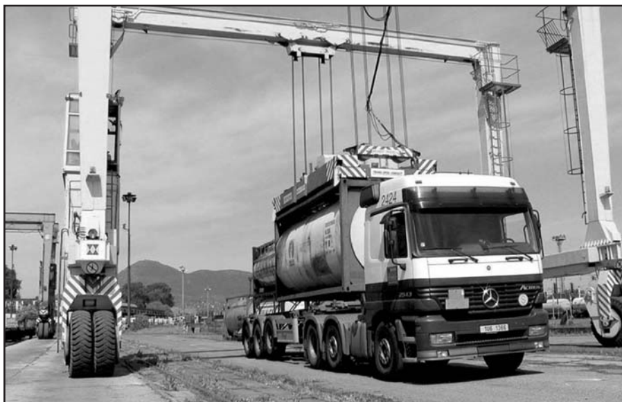
Tohle je současnost -Bohemiakombi. Jeřáb usazuje cisternu na nákladní vůz. Z dále přihlíží Lovoš...
