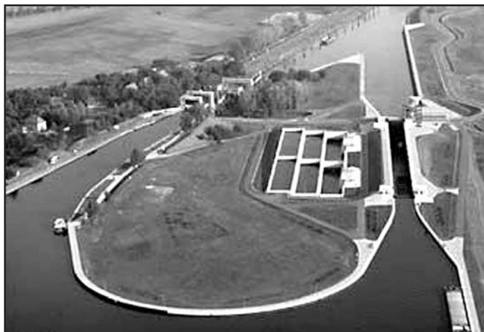
Na snímku je vpravo úsporné zdymadlo Rothensee a vlevo lodní zdvih Rothensee na západní spojení Labe / MLK ( http://www.wasserstrassenkreuz.de/ )
